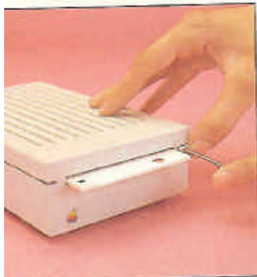
È estrarre il disco con il computer spento (o si deve inserire un ferretto robusto (nella foto) a braccia) mentre si tiene premuto il tasto di espulsione.
