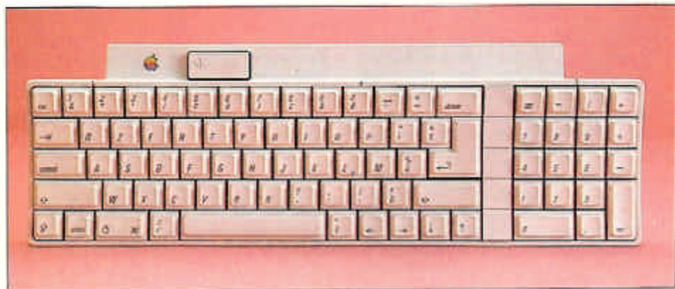
La tastiera dell'Apple IIgs, munita di tastierino numerico completo, si collega alla CPU con un cordone flessibile tramite la porta Desk Top Bus. Il grosso tasto in alto, vicino alla mela, è il Reset e va premuto contemporaneamente al control per avere effetto. Nuovo anche il primo tasto in alto a sinistra del tastierino numerico che corrisponde al vecchio Control X e quindi al Delete Line.
